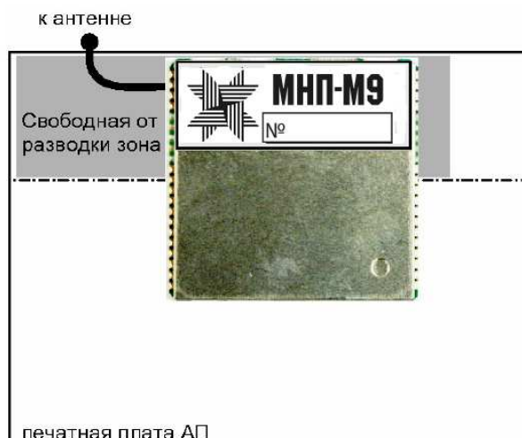
Рисунок 6 – Рекомендуемое расположение приемника МНП-М9.1 в АП
